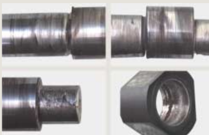
Bild 20: Verschleiß und Fresser an Exzenterwelle und Rolle einer Common-Rail-Hochdruckpumpe nach 189 h Dauerlauf mit Aviation Turbine Fuel F35 Figure 20: Wear and seizure on the eccentric shaft and roller of a Common-Rail high-pressure pump after only 189 hours endurance test with F35
