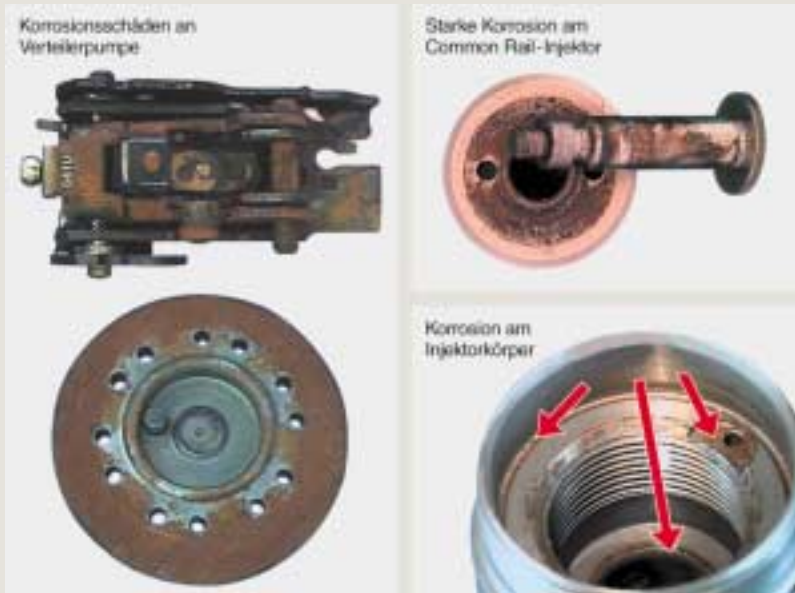
Bild 24: Rost und Korrosion an Bauteilen von Verteilereinspritzpumpe und Common-Rail-Injektor Figure 24: Rust and corrosion on components from distributor pump and Common Rail injector
